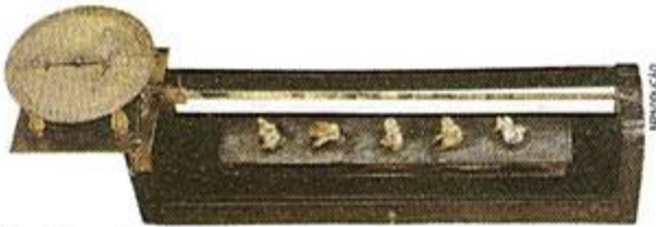
Modelo antigo de pirômetro de quadrante
